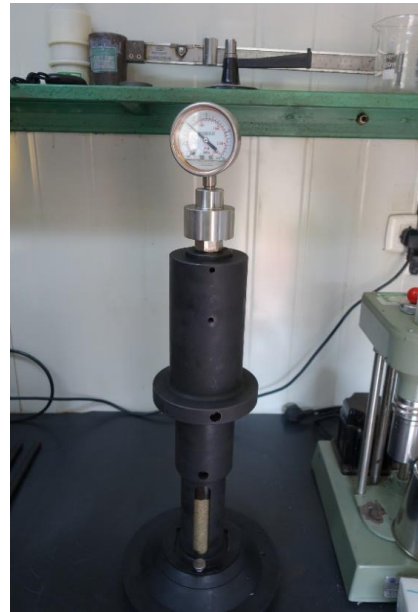
加入 1%ULIA ® 的井浆在 5MPa 压差下，30 分钟后砂床侵入深度仅 4.5cm
